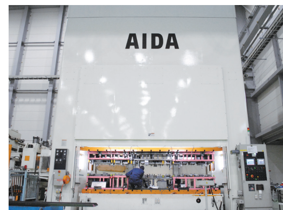
最大4.5mの順送金型を搭載できる1,600tトライ用プレス
