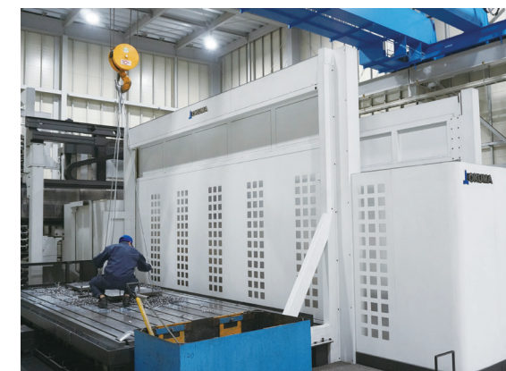
24時間稼働が可能なパレットチェンジャー付き大型5面加工門型MC
