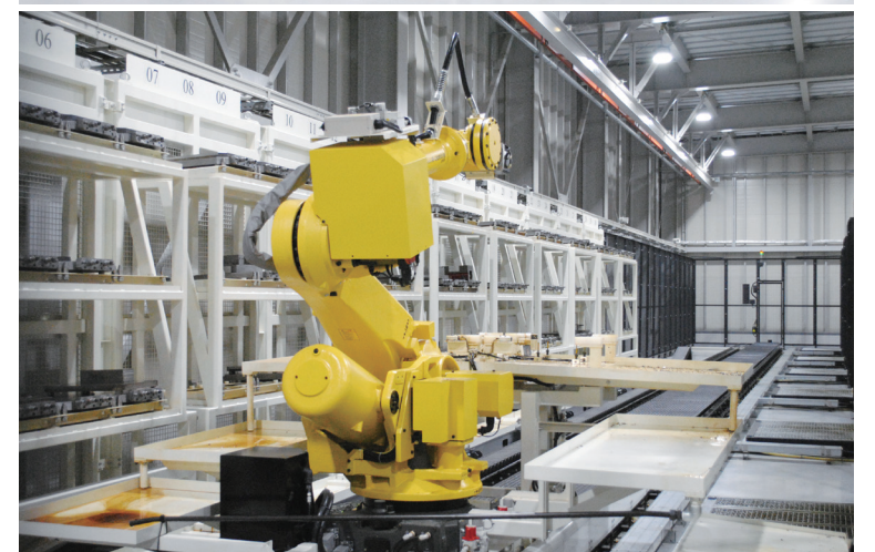
横型 MC 6 台と多関節ロボットによる「ロボットセル生産システム」
