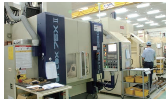
三井精機の5軸MC、安田工業のCNC治具ボーラーなどを備える
