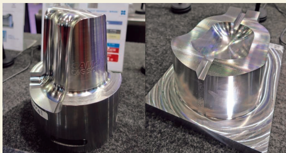
バレル工具・レンズ工具を使用した切削事例
