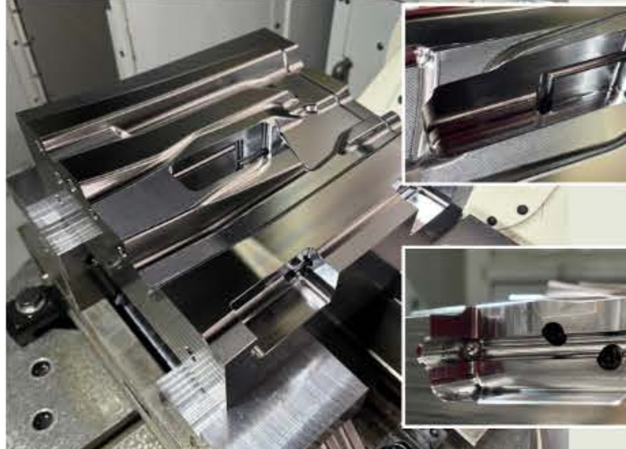
「G01交差穴あけサイクル」による穴加工効率化
