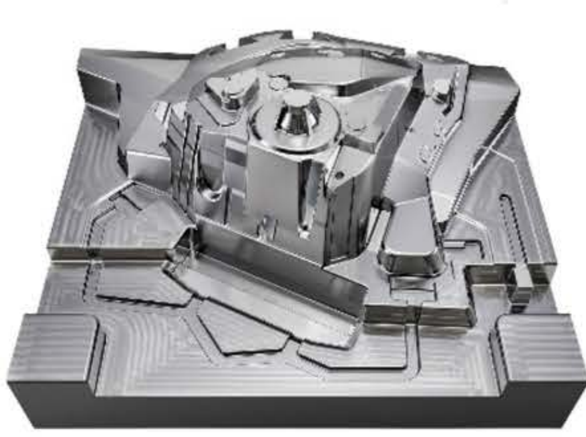
7軸制御加工機による大物金型加工事例
