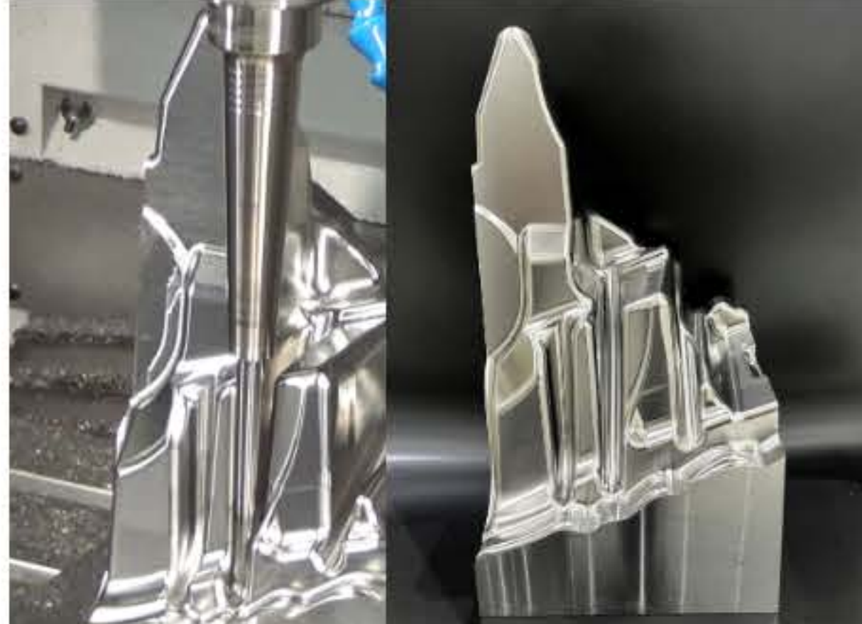
3軸加工（L/D=20）の安定した深リブ加工
