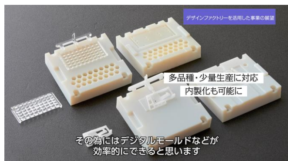
デザインファクトリーで作成したデジタルモールドと、射出成形した樹脂部品
