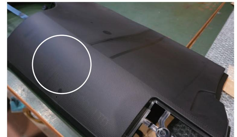
試作型による成形品。ウエルドライン(○部)を上ラインの延長線上来るようにコントロールしている
