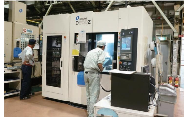
牧野フライス製作所製の金型向け5軸加工機「D200Z」
