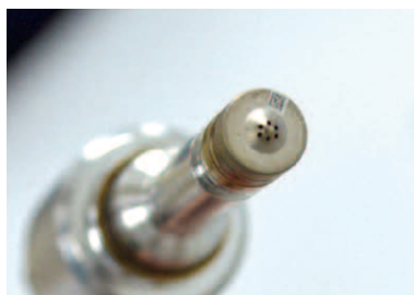
自動車エンジンの燃料噴射装置に使われるインジェクター。先端にφ0.358mmのノズル穴が6つあいている。
