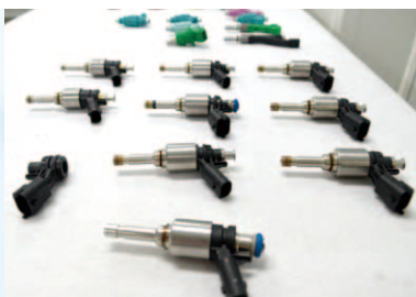
自動車エンジンの燃料噴射装置に使われるインジェクター。先端にφ0.358mmのノズル穴が6つあいている。
