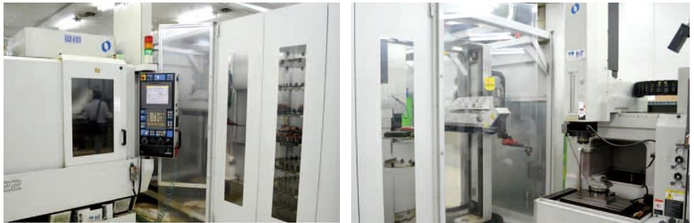
ロボットを使った金型加工の自動化。EROWA製のロボット7台が稼働中。
