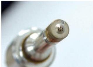
自動車のエンジンの燃料噴射装置に使われるインジェクター。先端に $\phi 0.358\text{mm}$ のノズル穴が6つあいている。
