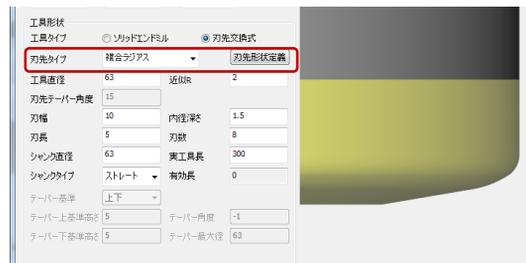
ツーリングDBに「複合ラジラス」を新設、高送りカッターの工具形状定義は、CAM-TOOLで作図した形状から作成可能です。
