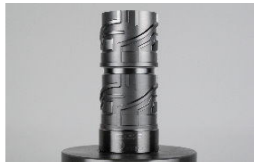
基準面オフセット加工による 鏡筒部品の5軸切削サンプル
