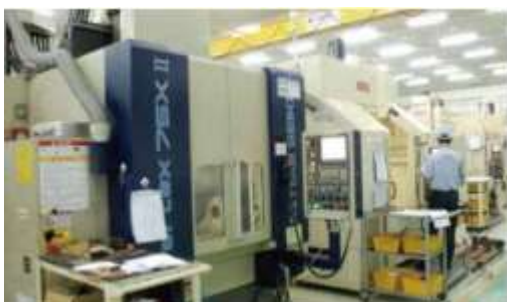
Được trang bị với trung tâm gia công 5 trục của MITSUBISHI SEIKI, CNC jig borers của YASDA và các hãng khác.
