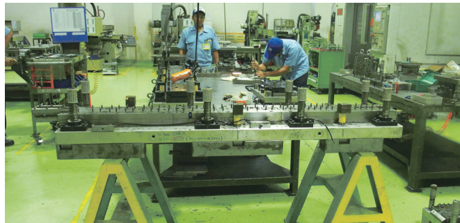
Progressive stamping dies dengan lebih dari 50 proses .
