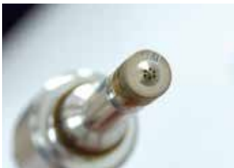
Injector yang Digunakan untuk Peralatan Injeksi Bahan Bakar Ada 6 lubang dengan diameter 0,358 mm untuk nozzle di bagian atas
