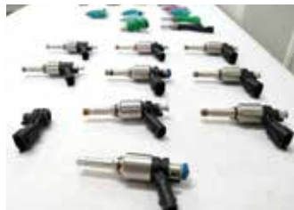
Injector yang Digunakan untuk Peralatan Injeksi Bahan Bakar Ada 6 lubang dengan diameter 0,358 mm untuk nozzle di bagian atas
