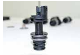
Katup Solenoid untuk Mesin Otomotif Perusahaan berhasil dalam pembuatan insert mold injeksi secara domestik
