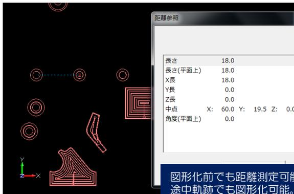
図形化前でも距離測定可能。途中軌跡でも図形化可能。
